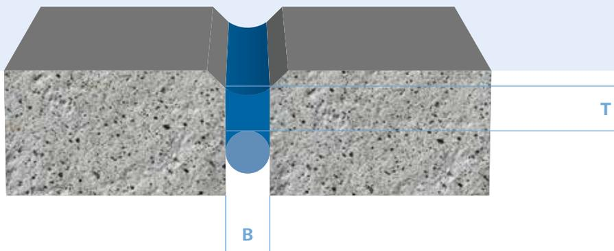
Die Fugendimensionierung ist abhängig von Baustoff, Temperatur, Bewegungen, Fugenlänge und Fugenabständen.
