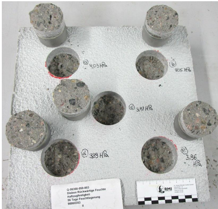
Abbildung 2: Bruchbild rückseitige Feuchteeinwirkung
