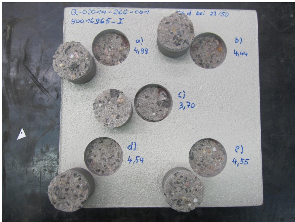
Abbildung 1: Bruchbilder Haftfestigkeit nach 56 Tagen 23/50
