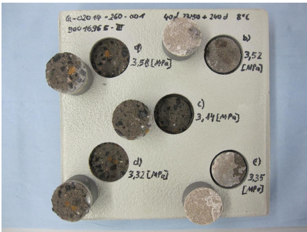
Abbildung 3: Bruchbilder Haftfestigkeit nach 40 Tagen 23/50 + 250 Tagen rückseitige Feuchteinwirkung
