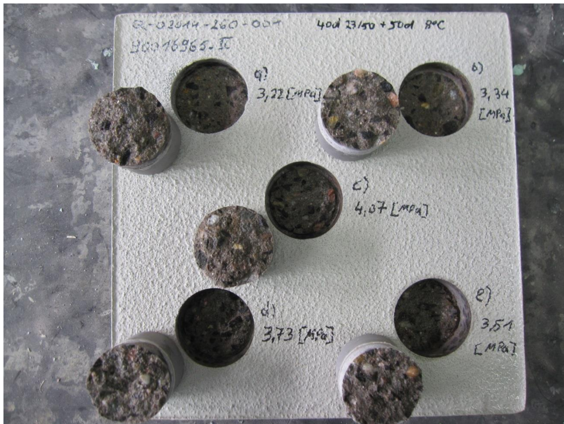
Abbildung 2: Bruchbilder Haftfestigkeit nach 40 Tagen 23/50 + 56 Tagen rückseitige Feuchteeinwirkung
